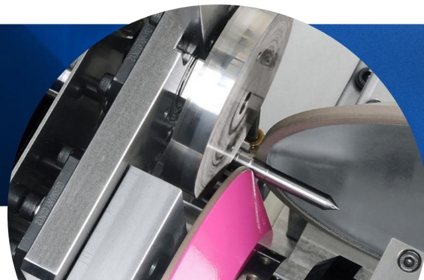
La station de retournement pour les ébauches nécessitant un usinage aux deux extrémités d'une pièce (jusqu'à 200 mm)
