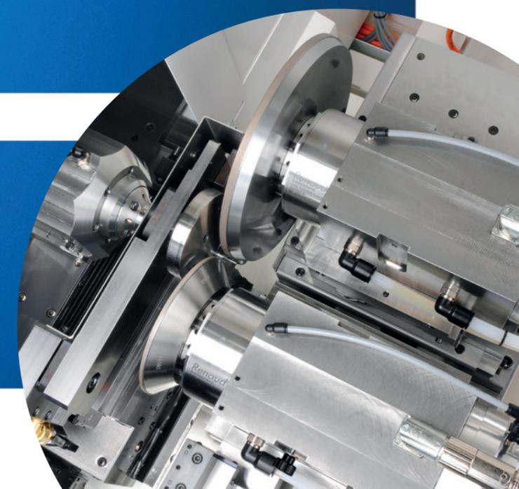
Le **nouveau design de la poupée**, avec entraînement en prise directe, offre plus de rigidité, une régulation de l'indexage plus fine et précise, notamment pour les applications nécessitant des plats ainsi que pour les poinçons de forme.
